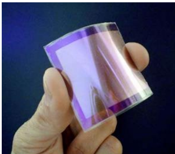
2.7 – сурет - Аморфты кремний негізіндегі иілгіш ФЭТ
