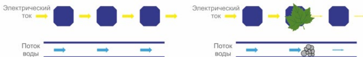
3.14 – сурет - Көлеңкеленген күн элементі бүкіл тізбек бойынша энергия ағынын бұғаттау имитациясы
